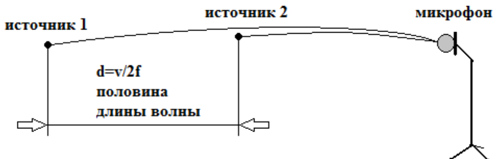
Рис. 2. Сигналы к микрофону придут в противофазе
